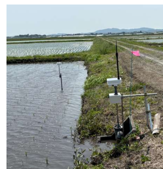
写真 水田ファーム 給水バルブと水位センサー
