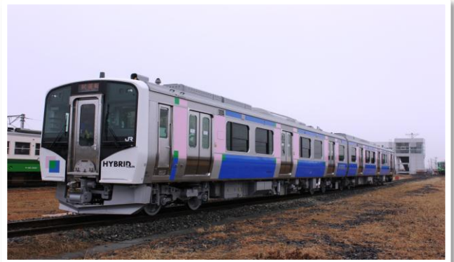
▲仙石東北ラインを走行するディーゼルハイブリッド車両
