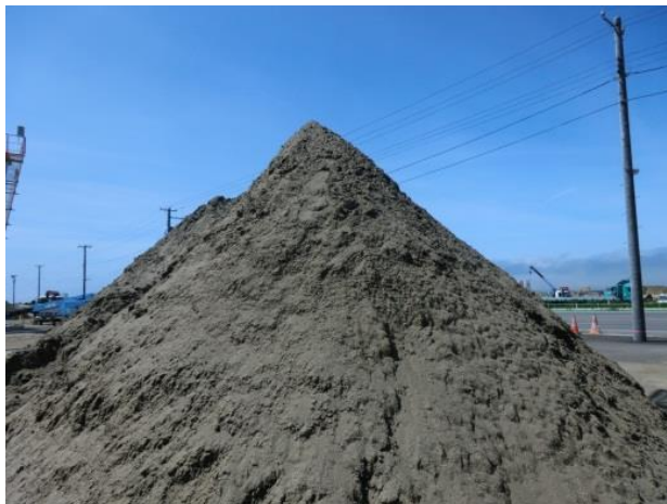
洗浄砂はサンドコンパクションパイル用 資材として利用
