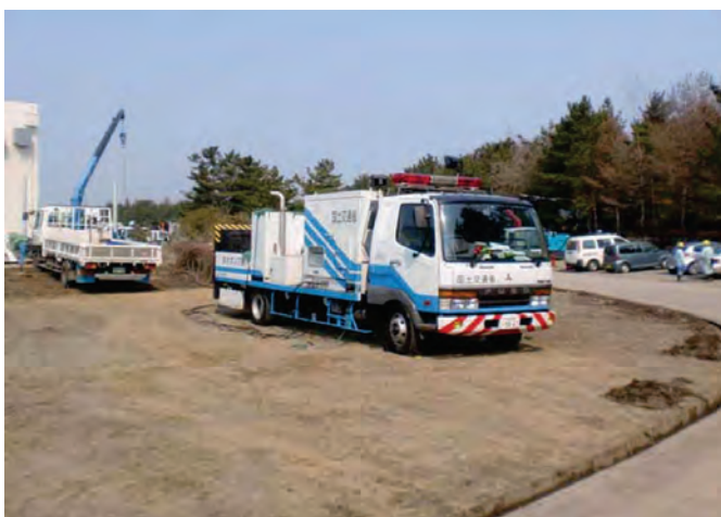
図 3-81 国土交通省排水ポンプ車
