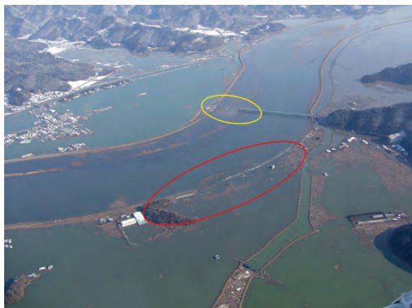
図 3-6 国道 398 号 新北上大橋の落橋 (黄色), 河北桃生線 北上川堤防上の道路が流出 (赤色)
