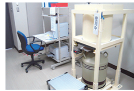
写真:放射性物質の検査器(ゲルマニウム半導体検出器)
