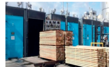
写真:木材加工施設(乾燥施設)
