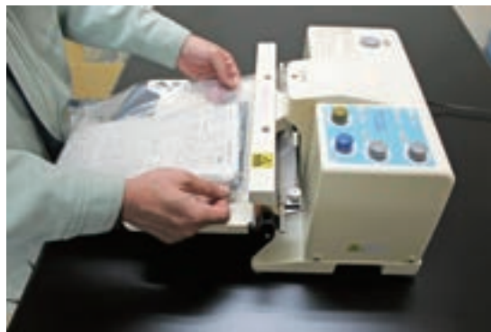
写真 6-10 カビ防止のためのシーリングパック作業
