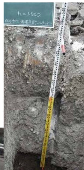
深さ 1.6m以上に達した亀裂
