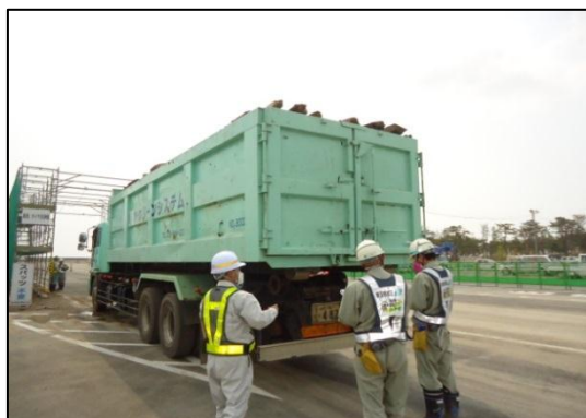
写真7-22 搬出時放射線量率確認状況
