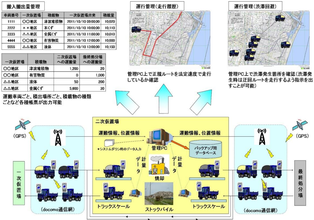
図7-10 搬入搬出量・運行管理統合システム
