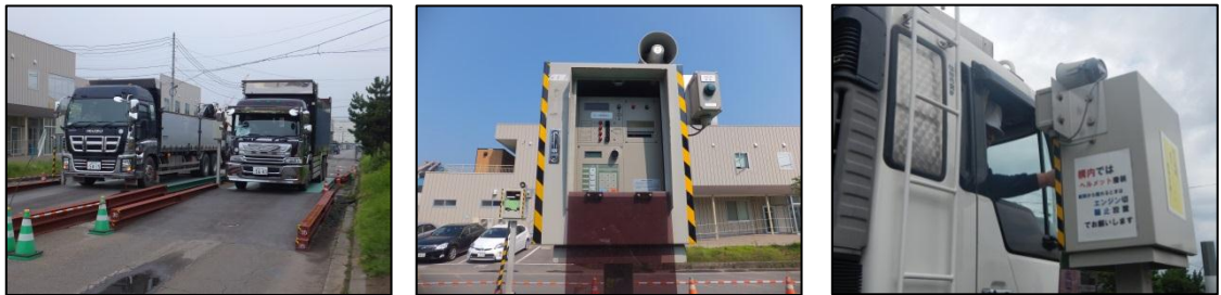
写真5-13 トラックスケール、パンチカード読み取り機（二次仮置き場A）
