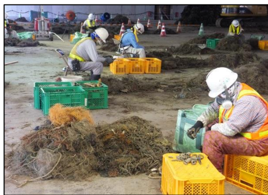
写真5-32 漁網手選別・鉛除去の状況
