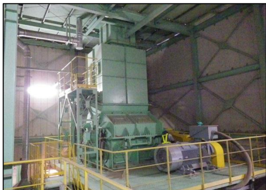
写真5-16 粗大混合破碎機 (粉じん飛散防止のため、密閉式)
