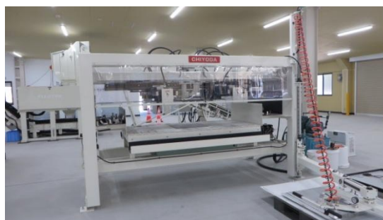
図 39：使用済太陽光パネルの処理設備
