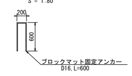
アンカー杭詳細図 S = 1:80
