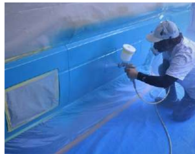
塗装機器操作実習 （スプレー塗装作業）
