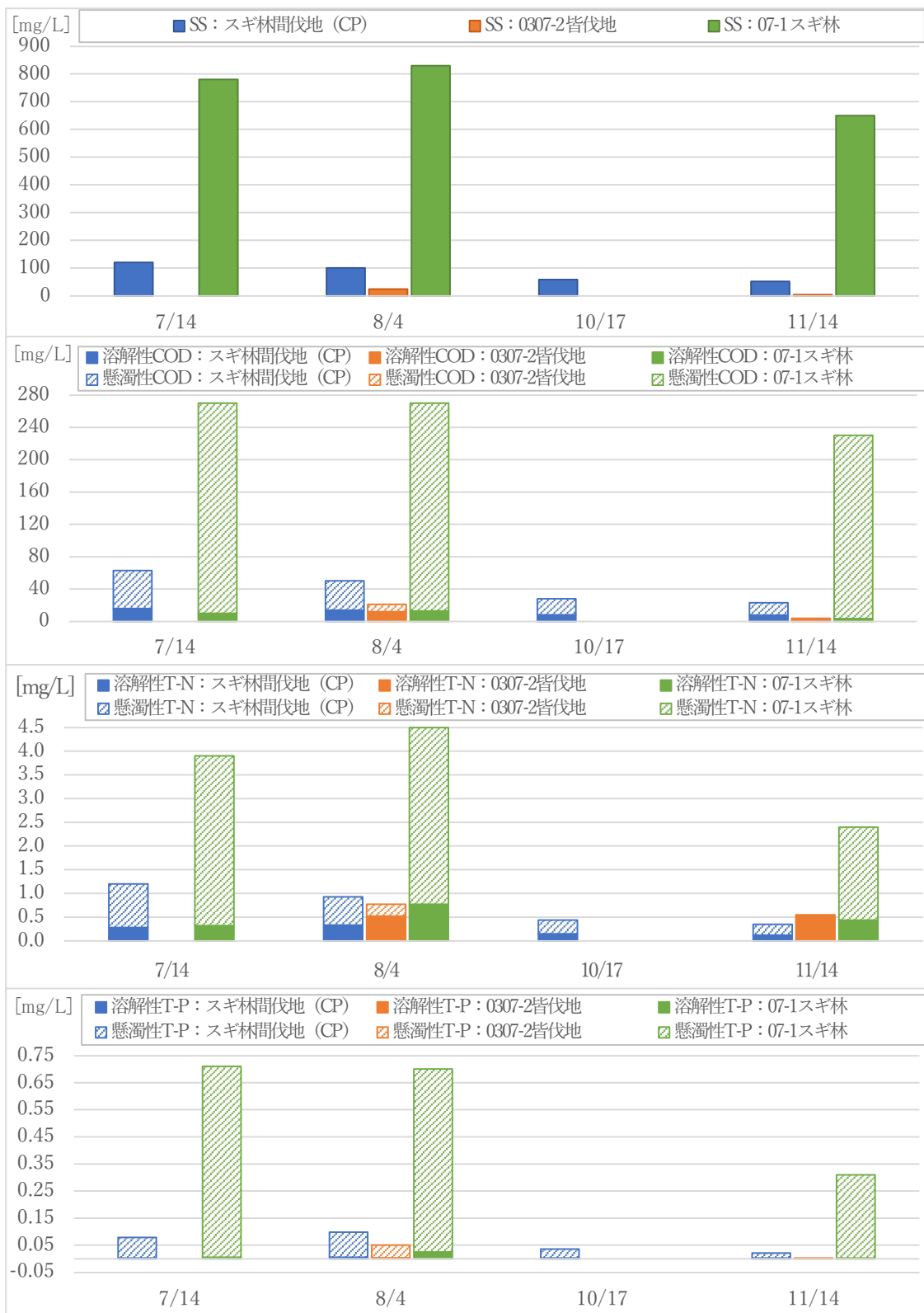
図 2-7 降雨時における水質分析の結果（濃度）
