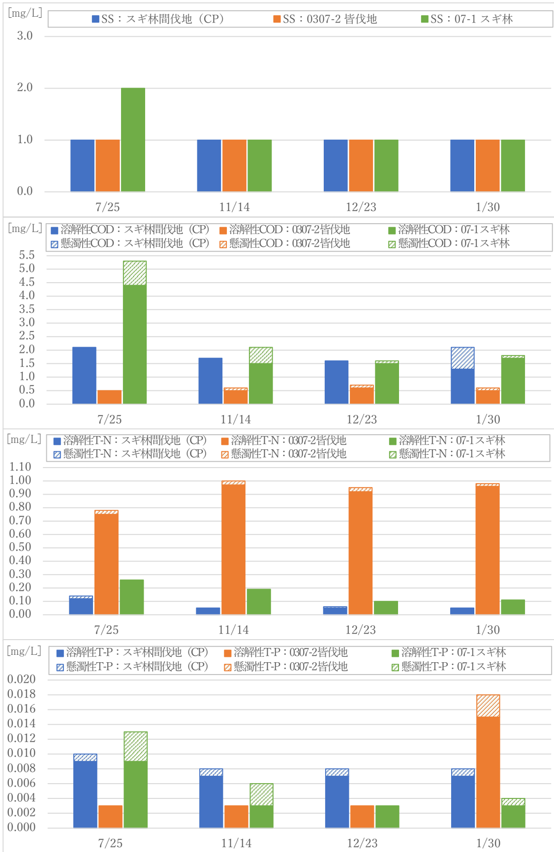
図 2-5 平常水位における水質分析の結果(濃度)
