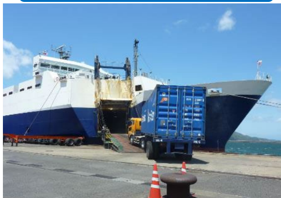
RORO船の荷役状況
