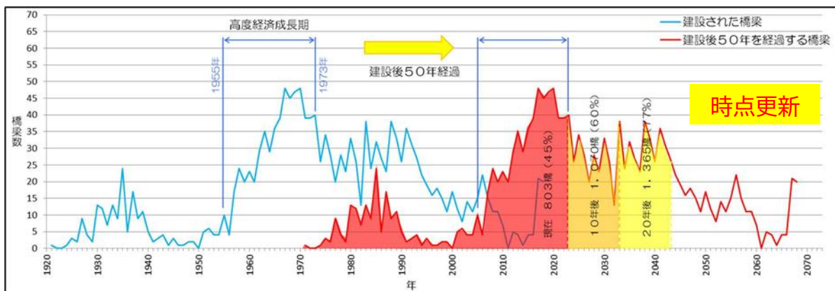
図4-6 完成年度別の宮城県の橋梁数 (出典：県道路課)
