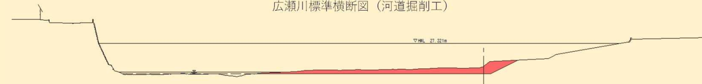
広瀬川標準横断面図（河道掘削工）
