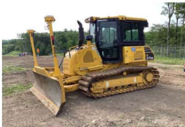
3D-MG/MCブルドーザ全景
