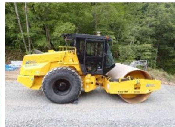
振動ローラ(土工用)全景
