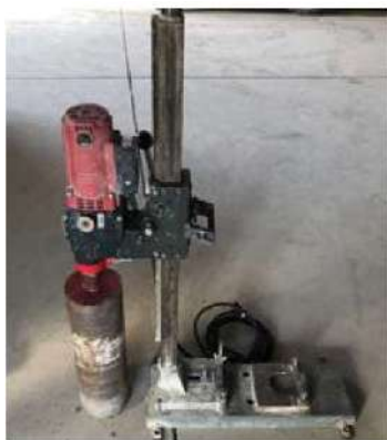
コンクリート穿孔機全景
