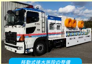
移動式排水施設の整備
