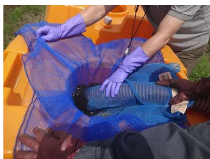
図12 搬送用のバキュームカーからタンクへの消化液の移送作業 注）濾（ろ）過には防風網とコンバイン籾袋を使用。
