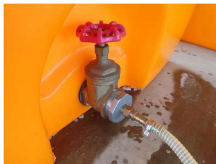
図12 500L容ローリータンクのドレンへのバルブ、ホースシステム（φ9mm）、PUホース（φ12mm）の装着例
