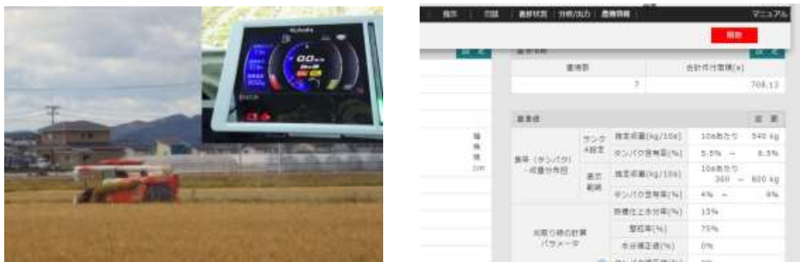
図4 営農管理システムへの収量・食味コンバイン（右）の収穫データの自動記録 注）収量、籾水分、玄米タンパク含量等、作業時間が自動で記録される。
