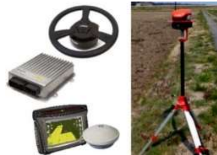
図2 自動操舵装置（後付）とRTK基地局「農水省HPから」
