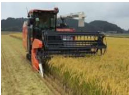
図9 自動走行コンバインによる収穫
