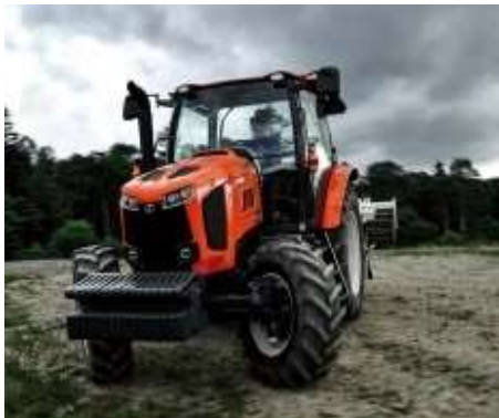
図1 GNSSアシスト操舵トラクタ
