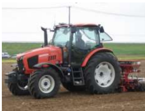
図1 GPSアシスト操舵トラクタと高速汎用播種機による播種作業
