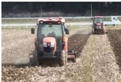
図2 ロボットトラクタ協調耕起作業
