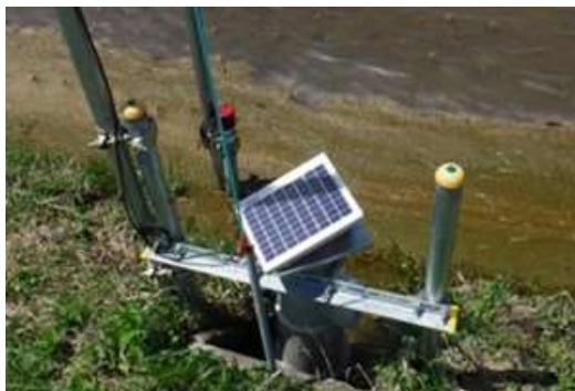
図4 自動給排水システム
