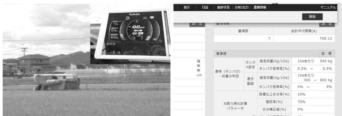
図4 ほ場管理システムへの収量・食味コンバイン（右）の収穫データの自動記録 注）収量，籾水分，玄米タンパク含量等，作業時間が自動で記録される。
