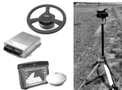
図2 自動操舵装置（後付）とRTK基地局「農水省HPより」
