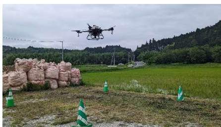
写真2 RTKを利用した自動航行デモ
