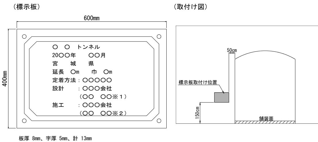
図6-2 標示板の設置イメージ図
