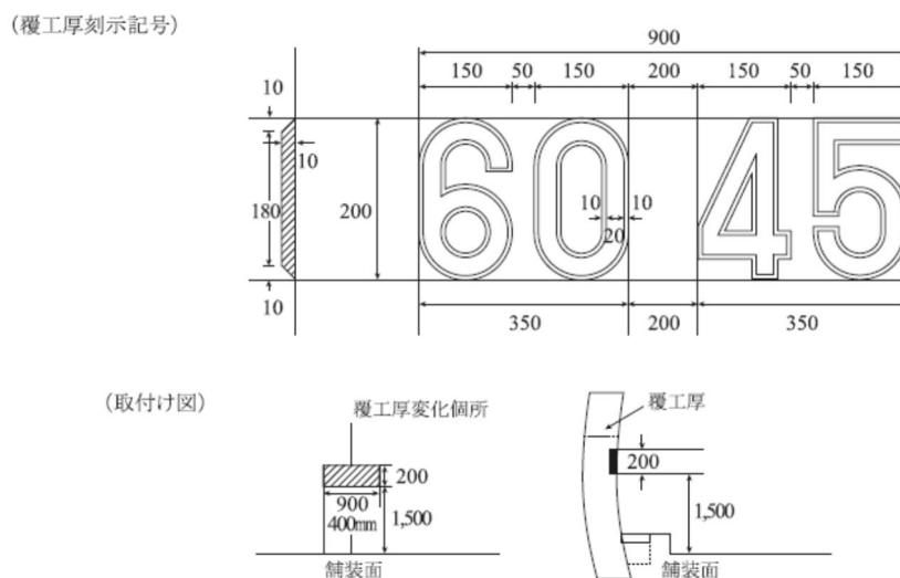
図6-1 覆工厚変化箇所の刻示標準図
