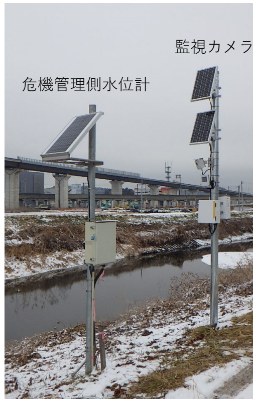
監視カメラ 設置状況（砂押川）
