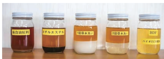
原料の廃食用油から BDF を製造するまでのフロー (提供：オイルプラントナトリ)
