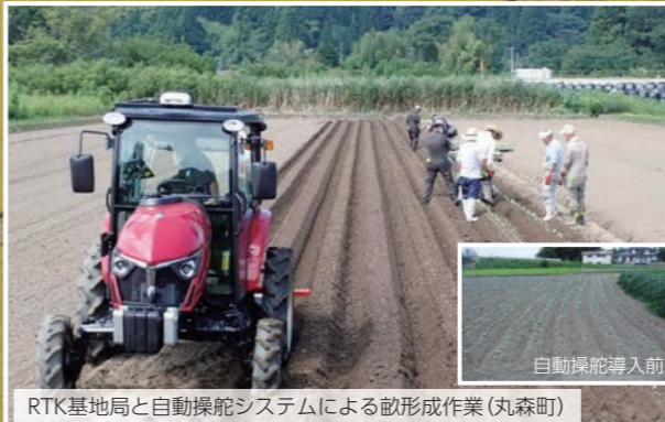
RTK基地局と自動操舵システムによる畝形成作業(丸森町)
