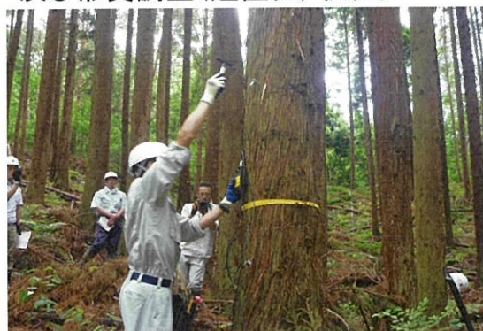
材質調査(ファコップの上下センサを立木に打ち込み, 打撃波の到達速度を計測)
