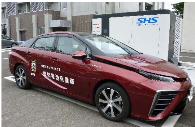
燃料電池自動車 TOYOTA MIRAI と スマート水素ステーション
