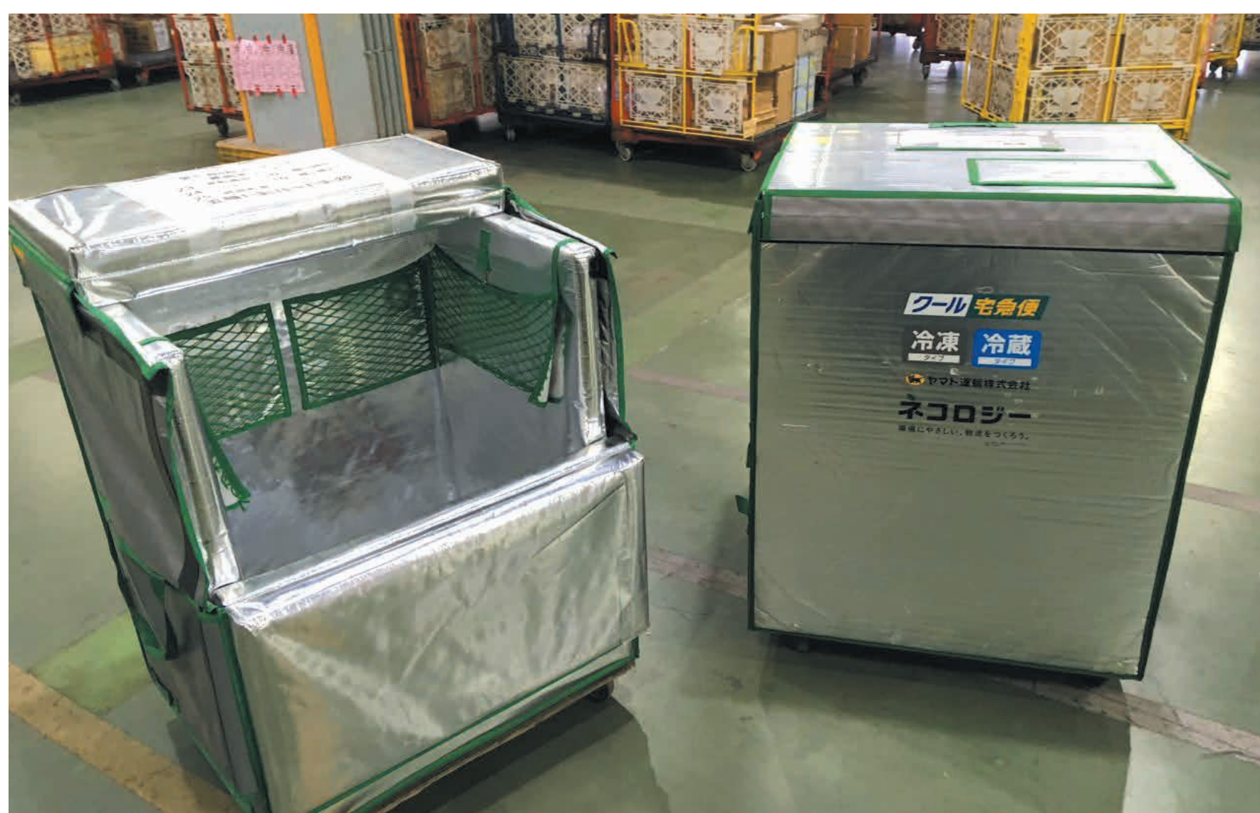
クール宅急便の一時仕分け用大型コンテナで、外気に触れる時間を最小に
