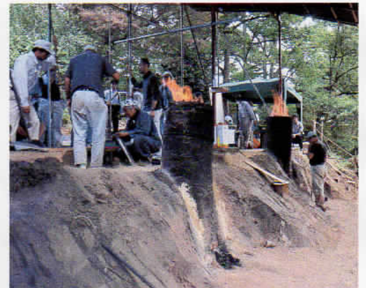
写真15 豎形炉による製鉄実験(福島市にて)
