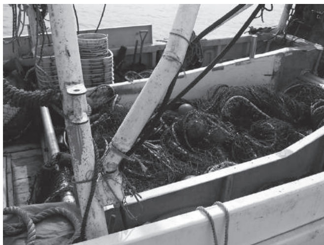
写真 船へ装備したガレキ回収装置
