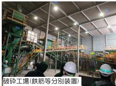
破碎工場(鉄筋等分別装置)
