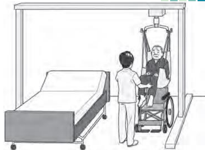
レール走行式リフト
