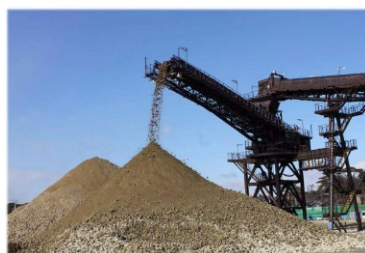
ベルトコンベア（最終落とし口部分は旋回型）延長 1,200m、幅 1.8m
