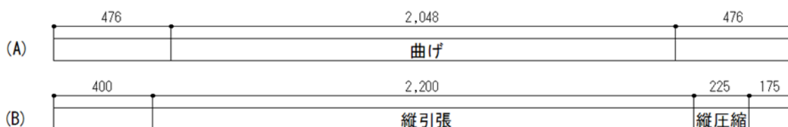
図—6 破壊試験試料材採取方法
