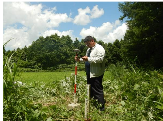
【GNSS測量機器による位置情報測定の様子】
