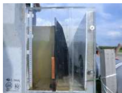
田んぼダム用堰板水利実験
