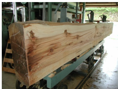
県産木材の利用加工技術の開発 （写真：スギ大径材の材質評価）
