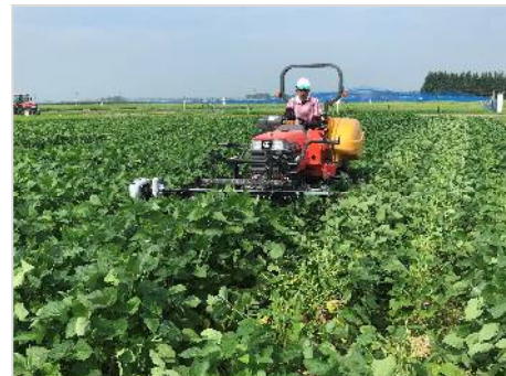
摘芯作業機による大豆の摘芯処理
