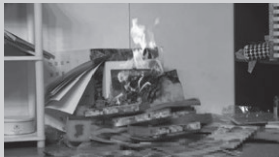
地震時に可燃物が飛散し、近くにあった電気ストーブに接触して発火
