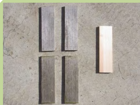
無塗装試験体の屋外曝露試験 右が試験前、左が試験後
