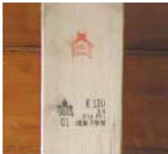
写真-1 製材品の強度等級区分 (ベイツガ)
