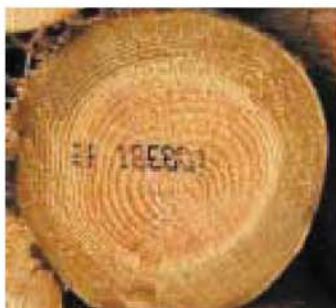
写真-3 丸太の強度等級区分 (嶺北木材協同組合 (高知県))
