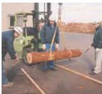
写真-2 丸太のヤング係数測定
