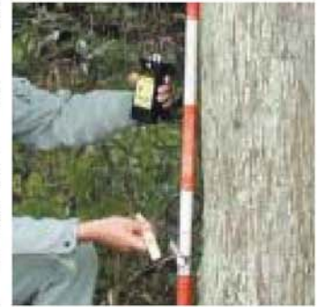
写真-4 立木のヤング係数測定
