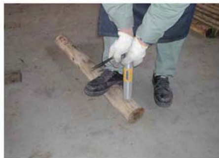
写真-3 測定機器による腐朽調査
