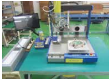
半田付けロボットによる ケース半田の様子
