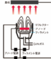
ダイヤモンドライクコーティング(DLC)イオン源模式図
