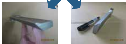
斜面と曲面を1つの形状に製作した工具による、 1軸送りによる3D切削加工
