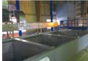
リン酸亜鉛皮膜処理層
