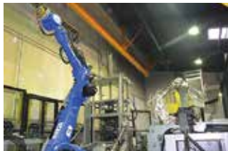
多関節ロボット鋳造機
